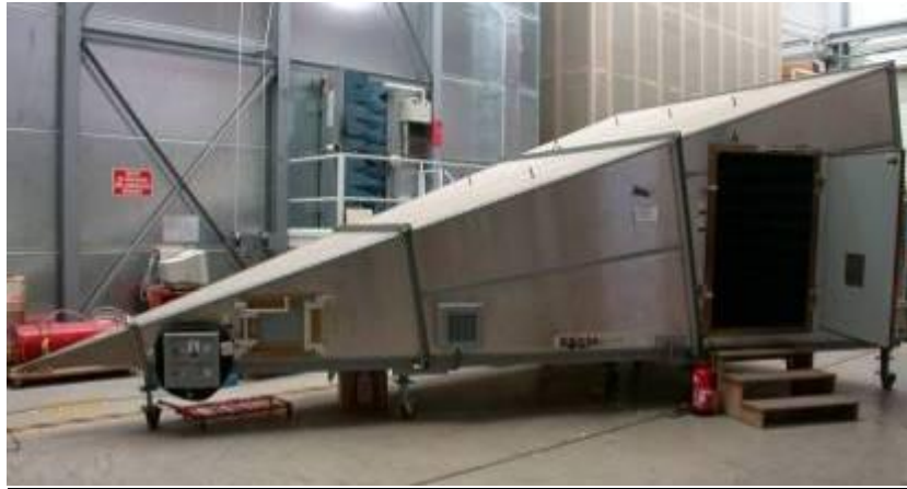
Figure 14 : Exemple de cellule GTEM de grande dimension (3 m x 1,6 m x1 m)
